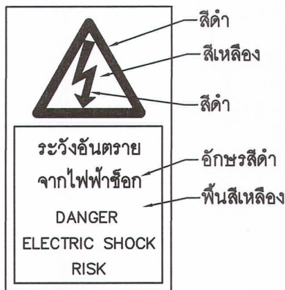
รูปที่ 11 ป้ายแสดงข้อความเตือนที่เครื่องอัดประจุไฟฟ้า
